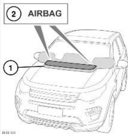
Некоторые автомобили могут быть оснащены подушкой безопасности пешехода. Подушка безопасности расположена под панелью в капоте. Слово "AIRBAG" (Подушка безопасности), расположенное по краям в задней части панели, подтверждает наличие подушки безопасности пешехода.
