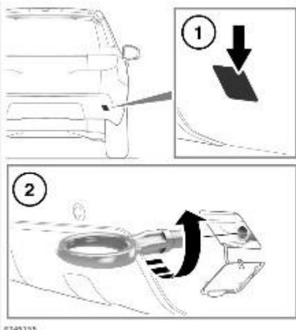
1. Снимите крышку доступа, нажав на нижний край, чтобы высвободить фиксатор. Крышка закреплена на бампере с помощью крепежного ремешка, но ее можно отсоединить, чтобы убрать в безопасное место.
