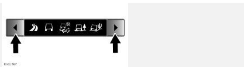
Используйте кнопки, расположенные на центральной консоли, чтобы переключаться между различными программами системы адаптации к дорожным условиям Terrain Response.
