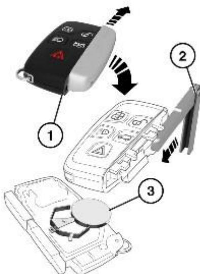
Уменьшение эффективного радиуса действия свидетельствует о необходимости замены элемента питания и сопровождается появлением на панели приборов сообщения **Smart Key Battery Low** (Разряжен элемент питания электронного ключа).
