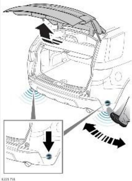
Датчики расположены в наружной части заднего бампера. Датчики распознают движение ноги ниже уровня бампера и обеспечивают автоматическое открывание или закрывание двери багажного отделения с электроприводом.
