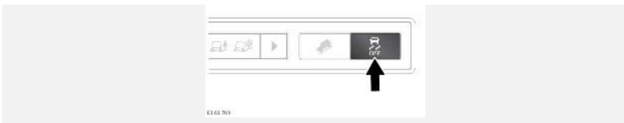
Чтобы отключить DSC, нажмите и кратковременно удерживайте переключатель DSC OFF (Выкл. DSC). Включится сигнализатор "DSC OFF" (DSC выкл.). См. [СИСТЕМА ДИНАМИЧЕСКОГО КОНТРОЛЯ КУРСОВОЙ УСТОЙЧИВОСТИ \(DSC\)](#). Кроме того, отключение
