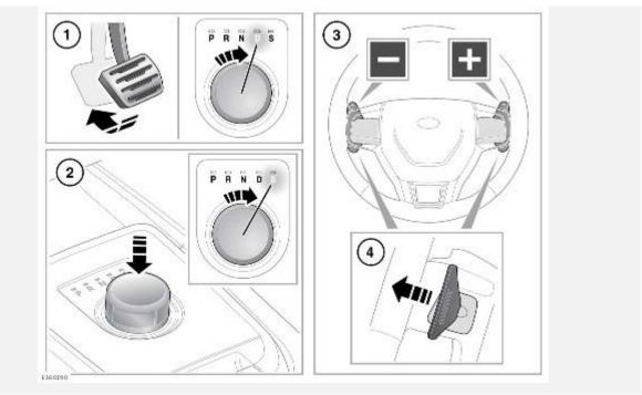
Поворотный селектор передач можно вращать против или по часовой стрелке. При включении двигателя селектор передач выдвигается из нижнего положения.
