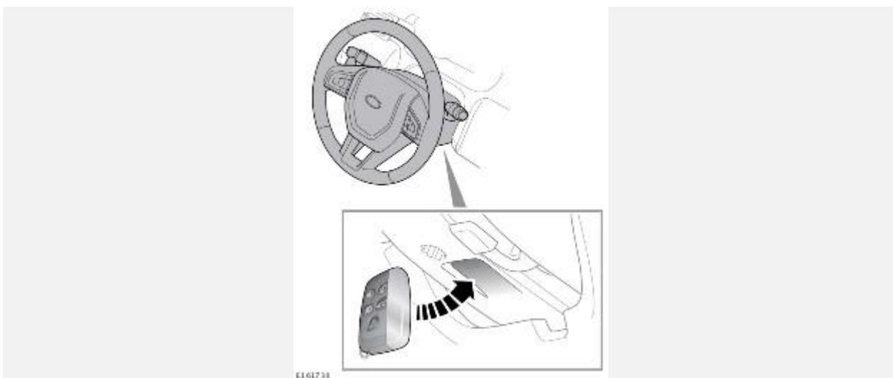
1. Плотно приложите электронный ключ к нижней поверхности кожуха рулевой колонки кнопками вниз.
