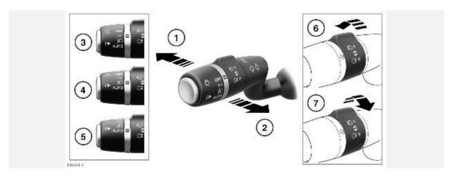
1. При включенных фарах нажмите переключатель от себя, чтобы включить дальний свет. Загорится сигнализатор на панели приборов. См. ДАЛЬНИЙ СВЕТ (СИНИЙ).
