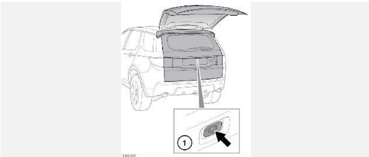
1. Нажмите кнопку, чтобы отпереть дверь багажного отделения, а затем поднимите дверь багажного отделения, чтобы открыть его.
