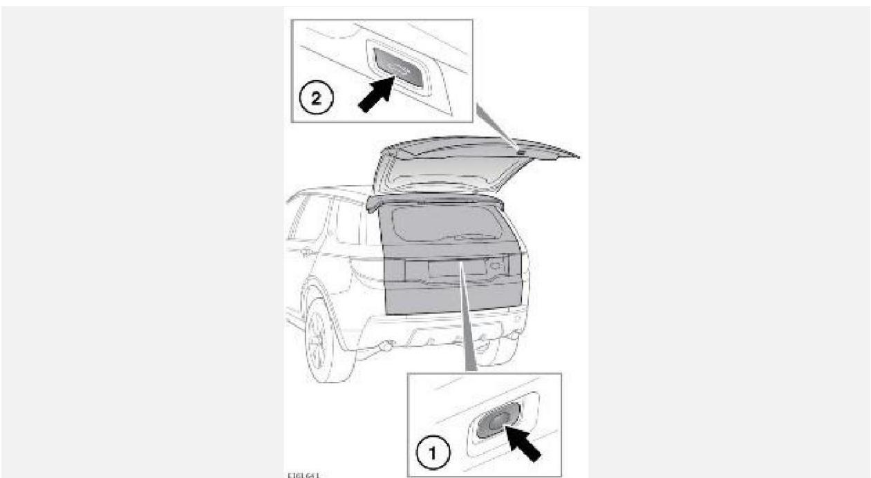
1. Нажмите кнопку, чтобы открыть дверь багажного отделения с электроприводом. Кнопку можно также использовать для остановки, изменения направления или закрытия двери багажного отделения.
