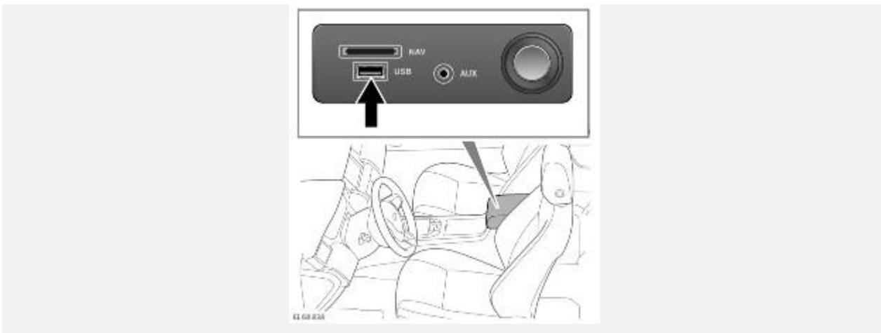
Для активации функции InControl Apps подключите смартфон с помощью подходящего кабеля USB к разъему USB в центральном вещевом ящике.
