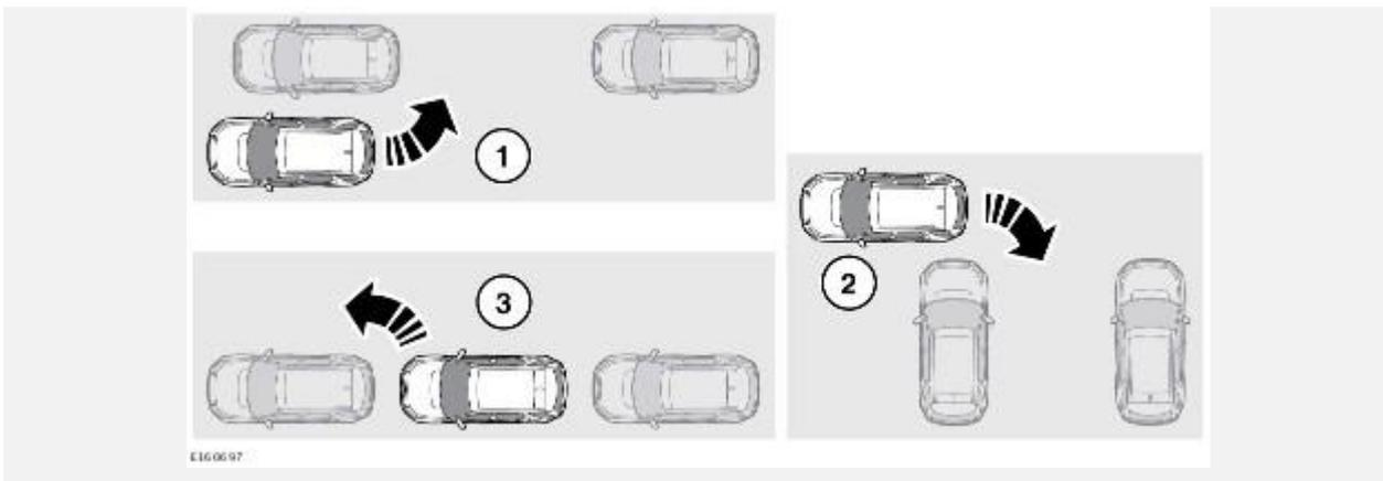
Система Park Assist помогает выполнять маневры въезда и выезда с парковочных мест и карманов для парковки автомобилей. Система Park Assist берет на себя рулевое управление и выполняет маневрирование автомобиля.
