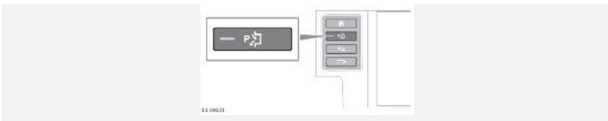
Включение системы выполняется однократным нажатием на кнопку Park Assist. В переключателе системы Park Assist загорится светодиодный индикатор.
