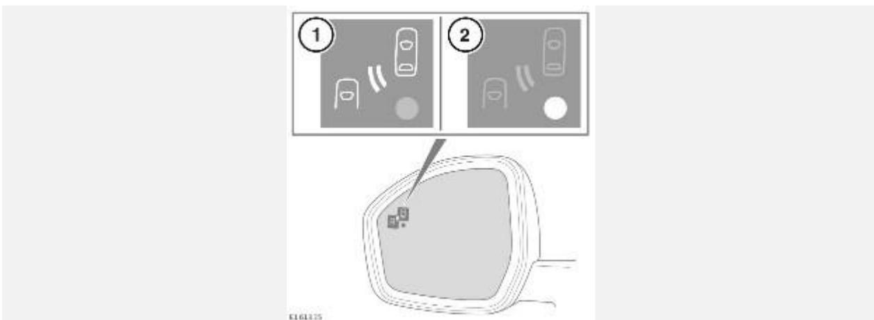
Если система BSM обнаруживает автомобиль/объект, обгоняющий вашу машину, на соответствующем наружном зеркале включается предупреждающий символ янтарного цвета (1), который обращает внимание водителя на потенциальную угрозу в "мертвой зоне" автомобиля и опасность перестроения в данный момент.
