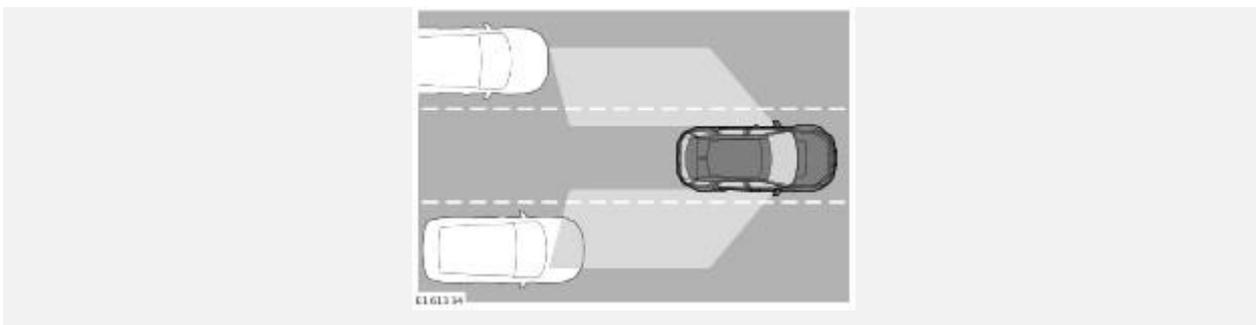
Система контроля "мертвых зон" (BSM) позволяет контролировать участки в непосредственной близости от автомобиля, которые не видны водителю, а также обнаруживать обгоняющие автомобили. Радары системы, расположенные по обеим сторонам автомобиля, выявляют обгоняющие автомобили и другие объекты в "мертвой зоне", игнорируя прочие объекты, которые неподвижны, движутся навстречу и т.п.
