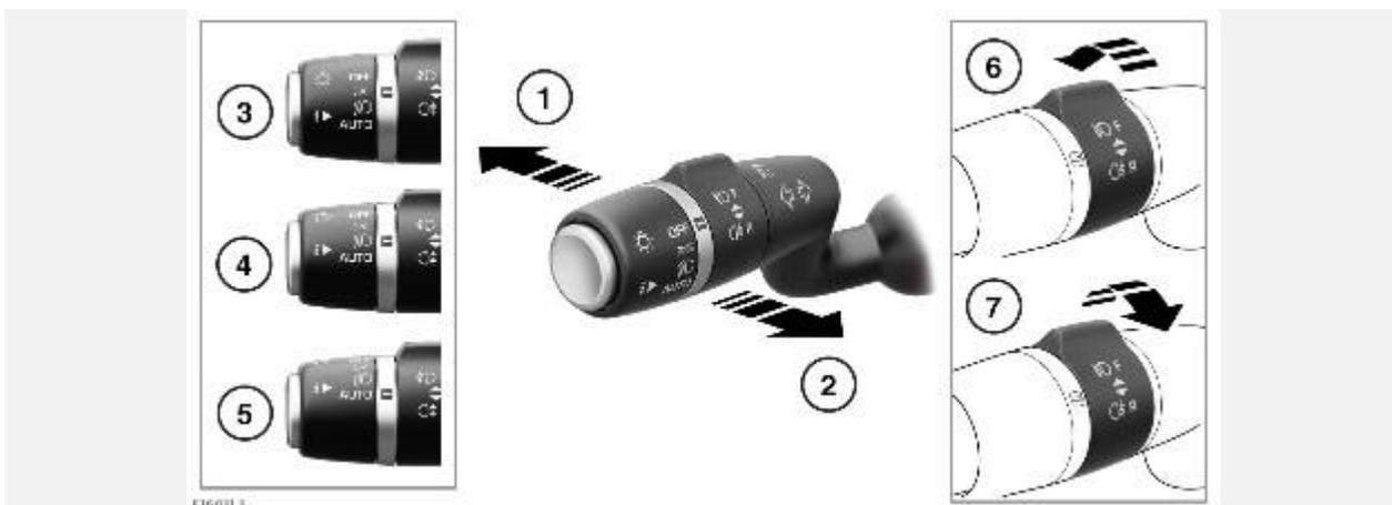
1. При включенных фарах нажмите переключатель от себя, чтобы включить дальний свет. Загорится сигнализатор на панели приборов. См. [ДАЛЬНИЙ СВЕТ \(СИНИЙ\)](#).
