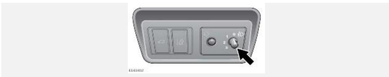
Угол наклона фар должен соответствовать нагрузке автомобиля. Нажмите выключатель, чтобы разблокировать его, а затем поверните в необходимое положение.
