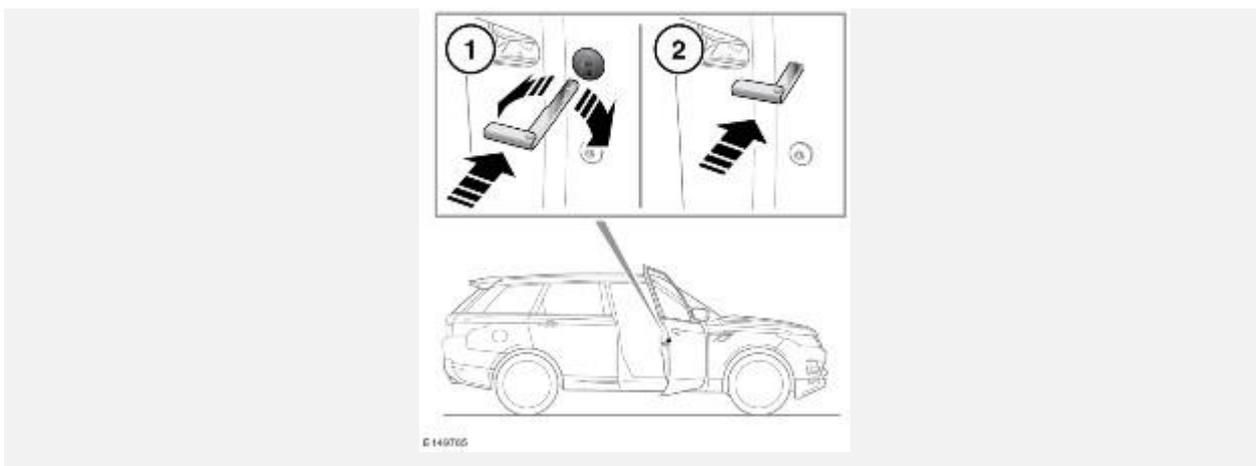
В случае разряда аккумуляторной батареи или неисправности системы запираения без ключа двери потребует запереть вручную.
