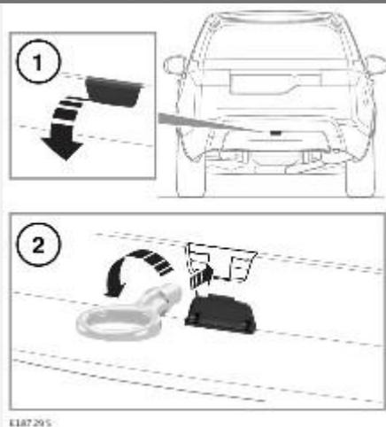
Буксировочная проушина входит в комплект инструментов автомобиля, который находится под панелью пола багажного отделения.
