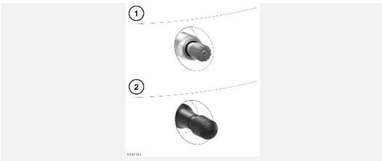
Колеса с системой TPMS можно отличить визуально по наружной металлической контргайке и ниппелю (1). На колеса всех автомобилей Land Rover, не оборудованных системой TPMS, ставятся обрезиненные ниппели (2).
