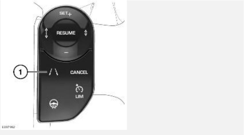
Для включения или выключения системы нажмите кнопку (1), расположенную на рулевом колесе. Для подтверждения статуса системы подсвечивается пиктограмма на кнопке.
