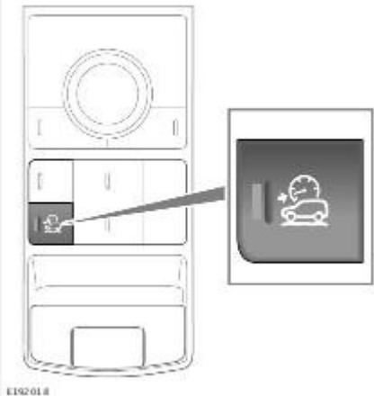
Чтобы включить систему ATPC, нажмите кнопку ATPC, расположенную на центральной консоли. На панели приборов отображается сообщение с рекомендацией задать скорость автомобиля. В подтверждение выбора загорается сигнализатор ATPC. См. [КРУИЗ-КОНТРОЛЬ НА НИЗКИХ СКОРОСТЯХ ПРИ ДВИЖЕНИИ НА РАЗЛИЧНЫХ ТИПАХ ПОВЕРХНОСТИ \(ATPC\) \(ЯНТАРНЫЙ\)](#).
