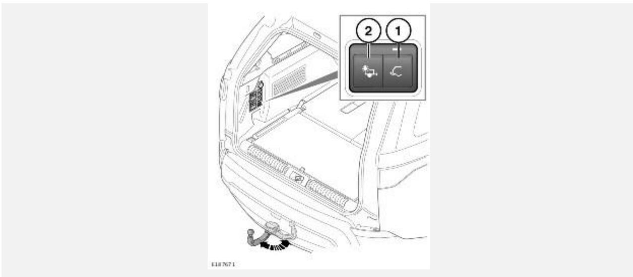
Сложить или разложить выдвижную шаровую опору также можно при помощи кнопок, расположенных в багажном отделении.
