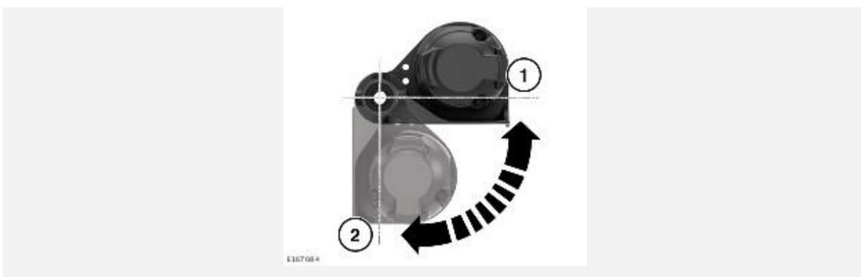
Разложите вручную электрический разъем (2), расположенный на тягово-цепном устройстве. Электрический разъем (1) необходимо складывать после снятия съемной шаровой опоры тягово-цепного устройства.
