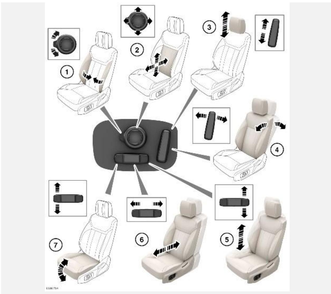
Отрегулируйте положение передних сидений с электроприводом следующим образом:
