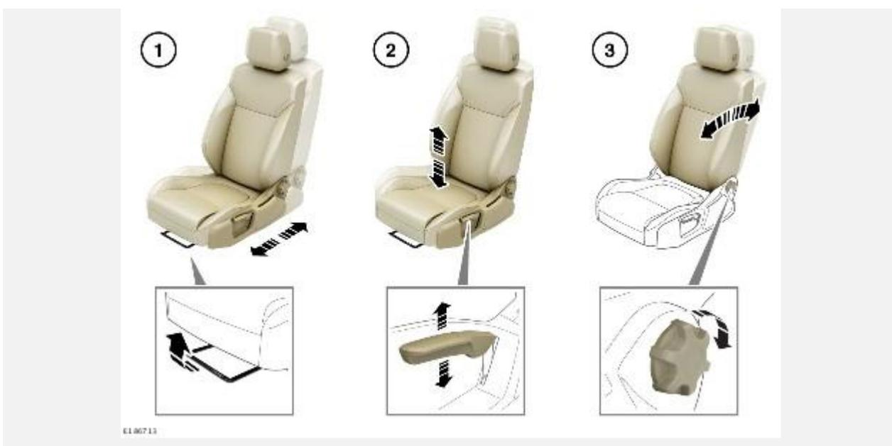
Отрегулируйте положение передних сидений с ручной регулировкой следующим образом:
