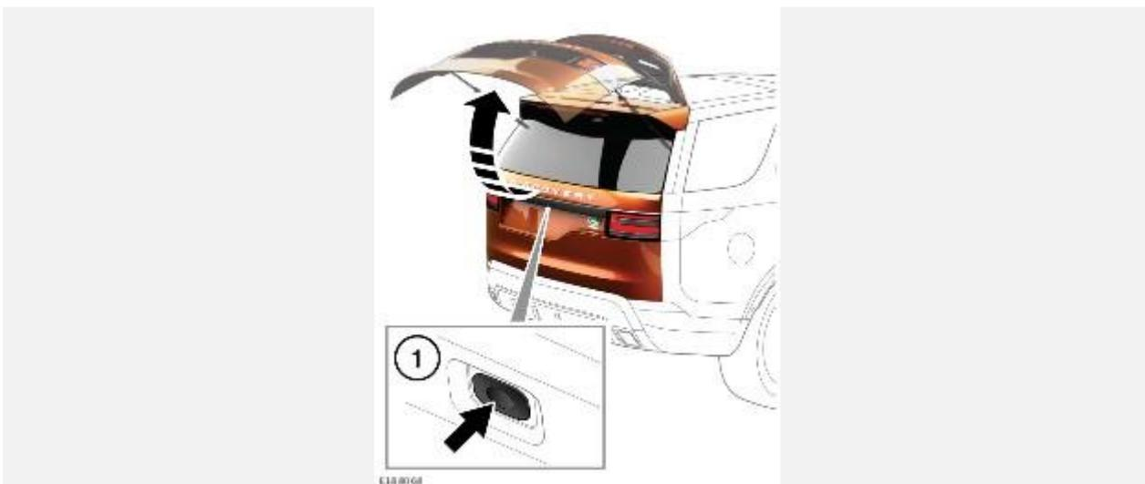
1. Наружная кнопка двери багажного отделения: нажмите для разблокировки, а затем поднимите дверь багажного отделения, чтобы открыть ее.
