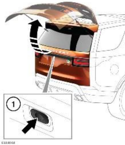
1. Наружная кнопка двери багажного отделения: нажмите для разблокировки, а затем поднимите дверь багажного отделения, чтобы открыть ее.
