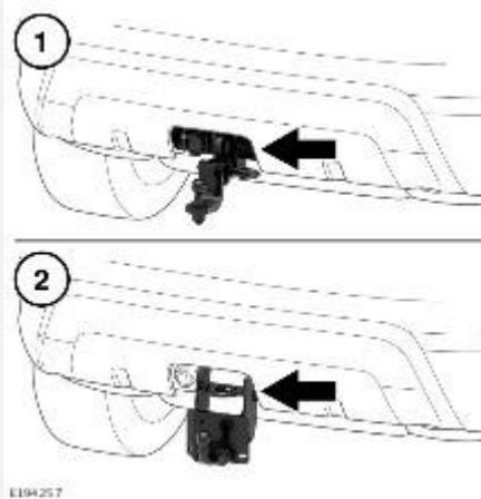
Буксировочная проушина в задней части автомобиля располагается в следующих точках:
