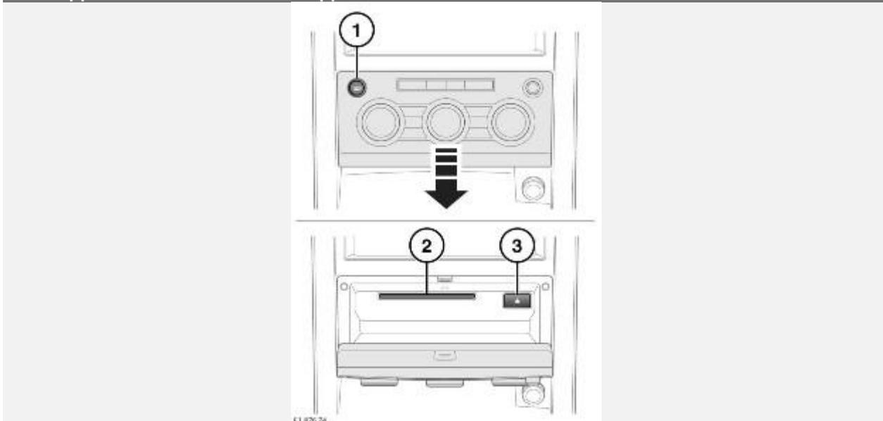
1. Нажмите, чтобы открыть откидную панель и получить доступ к слоту для загрузки CD-/DVD-дисков и кнопке извлечения.
