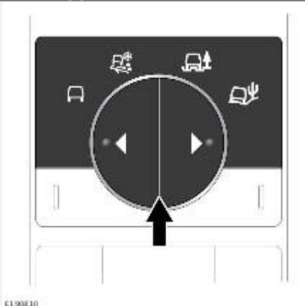
Выбор программы движения системы адаптации к дорожным условиям Terrain Response производится с помощью кнопок на центральной консоли. Нажимайте кнопки со стрелками "влево" или "вправо" для выбора программы движения системы адаптации к дорожным условиям Terrain Response. См. [ОРГАНЫ УПРАВЛЕНИЯ ВОДИТЕЛЯ](#).
