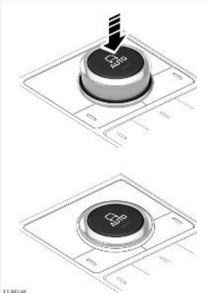
Некоторые автомобили оснащены автоматической программой движения (**AUTO**), которая определяет и выбирает наиболее подходящую к текущим условиям программу движения системы адаптации к дорожным условиям Terrain Response.
