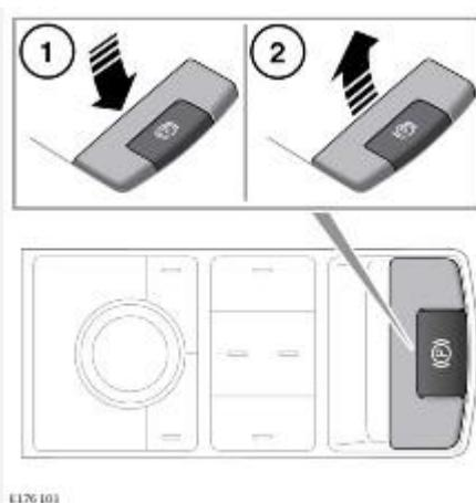
Переключатель EPB расположен на центральной консоли. Переключатель используется следующим образом:
