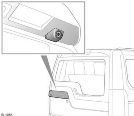
При включении задней передачи на сенсорном экране автоматически появляется цветное панорамное изображение пространства позади автомобиля.
