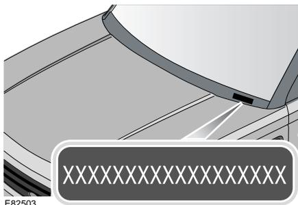
В качестве средства, отпугивающего угонщиков, и в помощь полиции номер VIN проштампован на пластине, которая видна через нижнюю часть левой стороны ветрового стекла (он должен совпадать с номером VIN в сервисной книжке). Номер VIN можно также найти в следующих местах: поверхности платформы защелки капота, стойки подвески и фаски закрытой двери.
