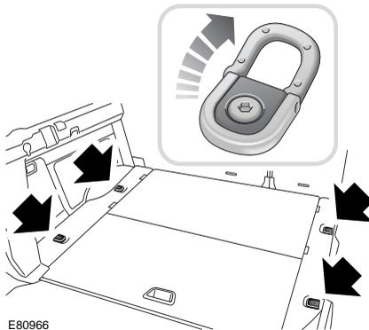
На заднем полу багажника находятся четыре точки крепления, помогающие надежно закрепить крупный багаж.
