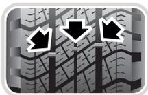
Если протектор изношен примерно до 2 мм, на его поверхности появляется индикатор износа. Он представляет собой резиновую ленту, проходящую через весь протектор, и служит визуальным указателем.
