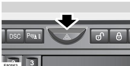
Нажмите и удерживайте кнопку Land Rover и нажмите выключатель аварийной сигнализации. Звуковой сигнал подтвердит программирование функции.
