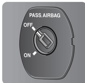
Перед установкой детского кресла на переднее пассажирское сиденье при помощи ключа зажигания поверните выключатель подушки безопасности в положение **OFF** (Выключена).
