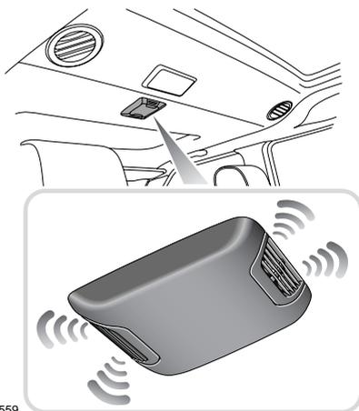
Четыре датчика, установленных в крыше, наблюдают за внутренним пространством и включают сигнализацию, если определяется движение воздуха в салоне.
