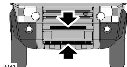
При помощи шланга направьте струю воды через передний бампер (места показаны стрелками) для удаления скоплений грязи с радиатора и конденсатора кондиционера воздуха.
