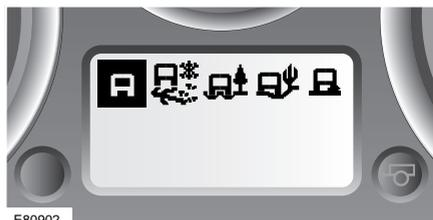
Если выключатель стартера выключить при включенной специальной программе, программа останется в памяти системы в течение шести часов и включится снова при последующем включении выключателя стартера (кроме режима «Grass-Gravel-Snow», который включен постоянно).
