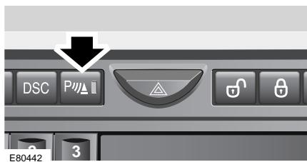
При управлении автомобилем в ограниченном пространстве система помощи при парковке передним ходом может быть включена вручную нажатием выключателя на центральной консоли (со стрелкой).
