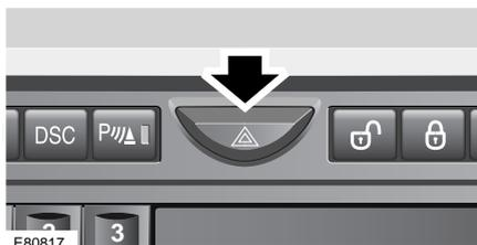
Для включения аварийной световой сигнализации нажмите данный выключатель. Все указатели поворота будут мигать одновременно.
