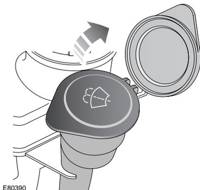
Из бачка омывателя жидкость подается на форсунки переднего и заднего стекла, а также на форсунки омывателя фар.
