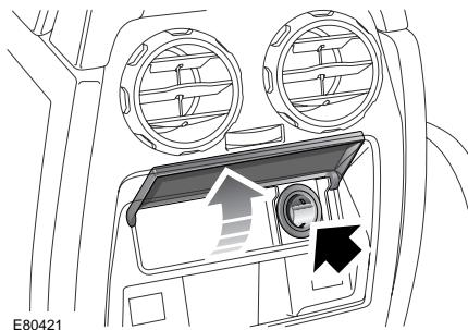
Для доступа к дополнительному гнезду электропитания поднимите крышку.
