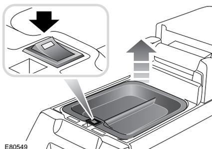
Мини-холодильник включается и выключается выключателем, который расположен на внутренней передней кромке камеры. Индикатор включается с небольшой задержкой после нажатия на выключатель.
