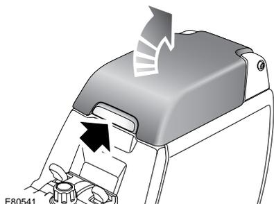
Поднимите защелку на передней панели крышки, чтобы открыть отсек для вещей.
