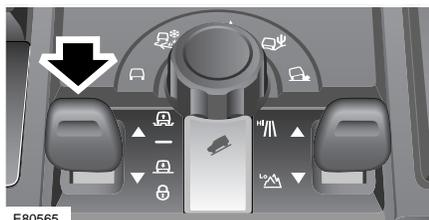
Нажмите и удерживайте кнопку Land Rover и нажмите выключатель подъема/опускания подвески. Звуковой сигнал подтвердит программирование функции.
