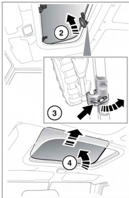
1. Поворачивайте рукоятку по часовой стрелке для открывания, против часовой стрелки – для закрывания люка.
