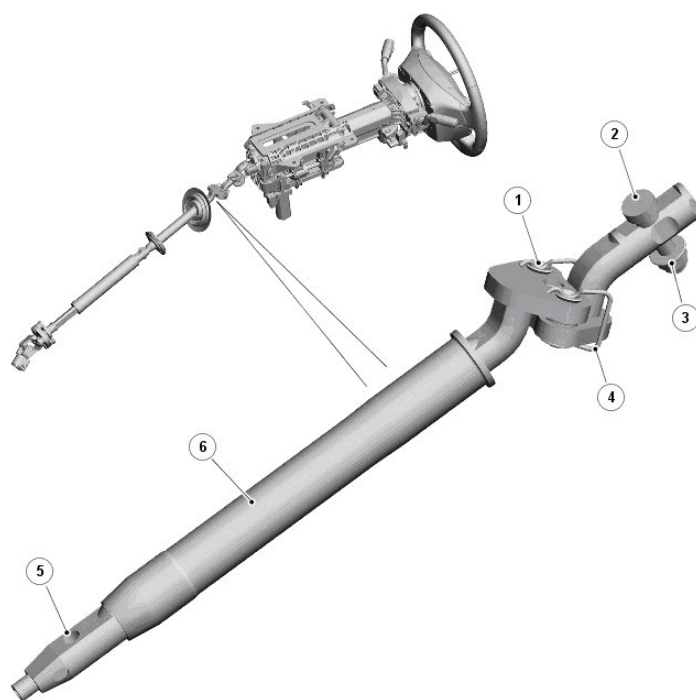
Рис.11. Промежуточный вал рулевой колонки Discovery и Range Rover Sport
