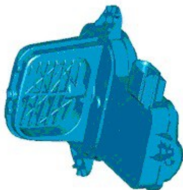
Рис.90. Впускной коллектор с переменной длиной впускного тракта бензинового двигателя 3.2L I6 Freelander 2
