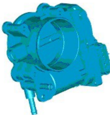
Рис.80. Электронная дроссельная заслонка бензинового двигателя 3.2L I6 Freelander 2
