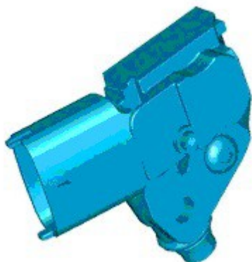
Рис.75. Датчик давления/температуры в топливной магистрали бензинового двигателя 3.2L I6 Freelander 2
