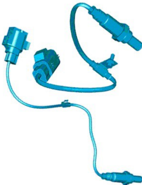
Рис.82. Подогреваемые кислородные датчики (HO 2 S) бензинового двигателя 3.2L I6 Freelander 2
