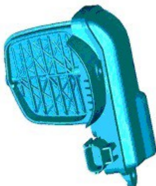
Рис.91. Впускной коллектор с переменным объемом камеры бензинового двигателя 3.2L I6 Freelander 2
