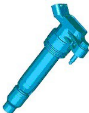
Рис.88. Катушка зажигания бензинового двигателя 3.2L I6 Freelander 2
