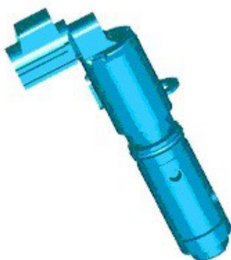
Рис.86. Электромагнитный клапан регулируемого газораспределения (VCT) бензинового двигателя 3.2L I6 Freelander 2
