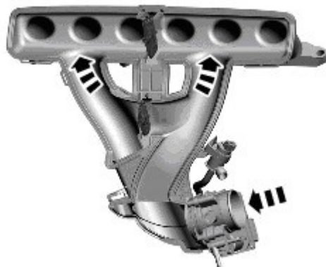
Рис.64. Обе дроссельные заслонки закрыты. Воздух направляется по длинному тракту.
