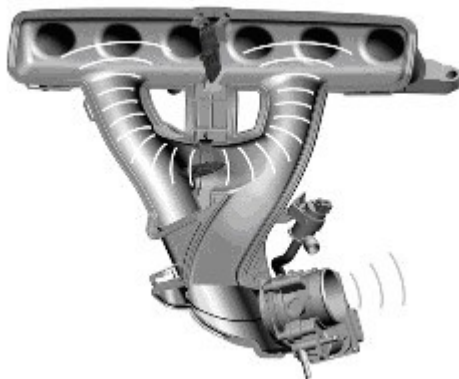
Рис.66. Нижняя дроссельная заслонка открыта, в то время как верхняя дроссельная заслонка закрыта.
